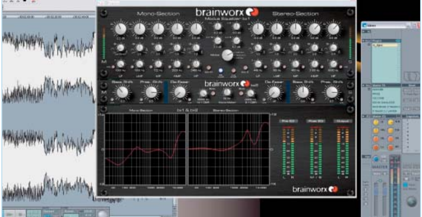
Das GUI des Plug-ins bx_digital von Brainworx wartet neben dem fünfbandigen EQ mit einem wirksamen De-Esser, Bass- und Presence-Shiftern und einem so genannten Mono-Maker auf. Das integrierte M/S-Verfahren führt zu ungeahnten Editier-Möglichkeiten.
